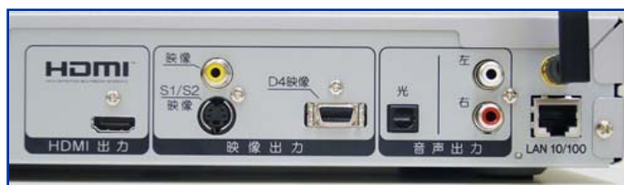
映像はコンポジット/S端子(S2対応)/D端子(D4出力対応)、音声はアナログ1系統+光デジタル出力を装備し、これにHDMIがかわる
