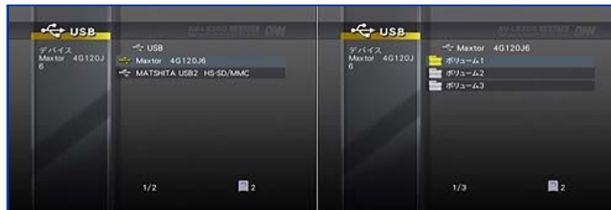
USB接続のHDDとメモリーカードリーダーを接続したところ(左)。複数のUSBデバイスを接続した場合でも任意のデバイスを選択してコンテンツの再生が行える(右)。また複数パーティションにも対応しており、USB接続HDDの利用制限はほとんどなくなった
