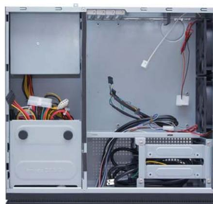
「NSK2450B」はユニークな三部構造により、電源/マザーボード/ハードディスクを別々のユニットに隔離し、システムからの熱伝導を防ぐと共に動作音を抑制します。さらに振動ノイズを抑える静音技術を各ユニットに施しています。電源/光学ドライブユニットと梁(筐体)には、接地面に対して振動防止ゴムグロメットを装備し、ハードディスクユニットには、シリコンクリップとシリコングロメットを備え、振動を吸収しノイズを低減いたします。エアフローにも優れ、マザーボードユニットには速度調節が可能な120mmファンを2基搭載し、電源/ハードディスクユニットには通気窓を採用しています。また効率のよいエアフロー環境を実現するために、電源コネクタ類/フロントコネクタ類/ハードディスク電源コネクタ類のケーブルマネージメントを行うことができます。
