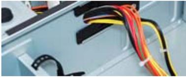
電源ユニットとマザーボードユニットを仕切る部分には、電源コネクタなどを通す、ケーブル用の穴(スライド式)を備えています。優れたケーブルマネージメントを行うことができ、エアフローの障害となるケーブルを効果的にまとめることができます。
